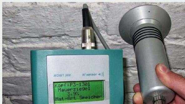
Figura 4 – Igrometro da cantiere a microonde. L'assorbimento di microonde nella struttura è influenzato dal contenuto di umidità: facendo attraversare il materiale da un fascio di neutroni, ovvero di microonde, si avrà un'attenuazione della loro energia iniziale a opera dell'acqua. È una misura sofisticata e richiede personale qualificato.
